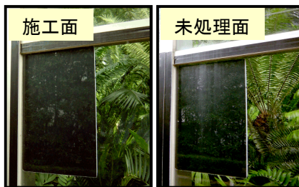
写真：5ヶ月後の雨筋汚れに対する防汚性能評価結果(左施工面、右未処理面)
